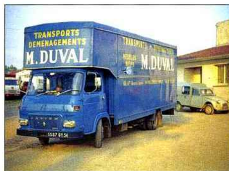
Ci-dessus — La caisse de ce Saviem SG4 de 1973 utilise une armature en acier sur laquelle reposent une tôle d'aluminium extérieure, une toiture en polyester et un capitonnage intérieur.
